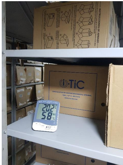
Medidor de temperatura y humedad en el archivo central.
